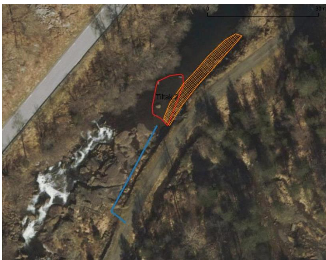
Figur 59. Tiltak omfatter fjerning av sand og produsert grus, samt utlegging av mindre mengder gytegrus ved utløpet av en kulp. Blå linje viser beste atkomstvei for gravemaskin. Utgraving av groper for utlegging av gytegrus bør gjøres strategisk rundt blokker som viser i flybildet. Oransje felt har både produsert grus, sprengstein og i øvre del mye rein sand. Mye av dette vil kunne nås med gravemaskin fra turvegen.
